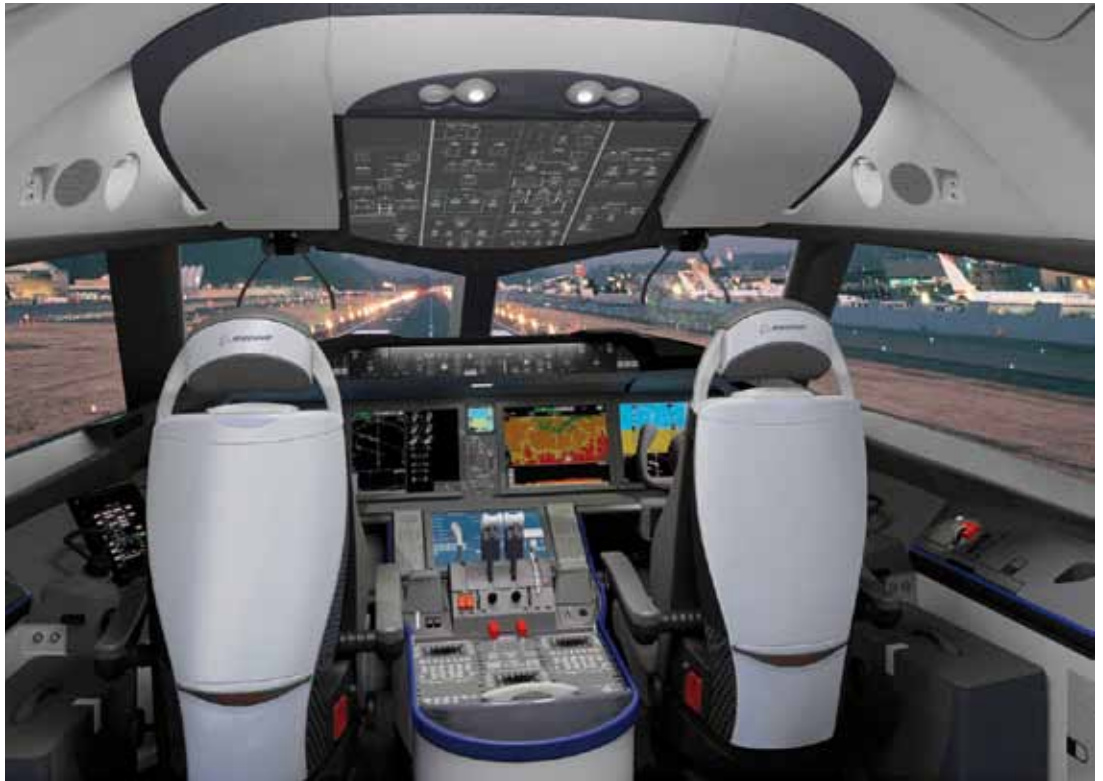
Bild oben: Im Cockpit des B787 macht vor allem das neue, erstmals serienmässig eingebaute Head-Up Display (HUD) für Captain und Kopilot von sich reden.
